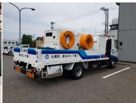
大型排水ポンプ車
